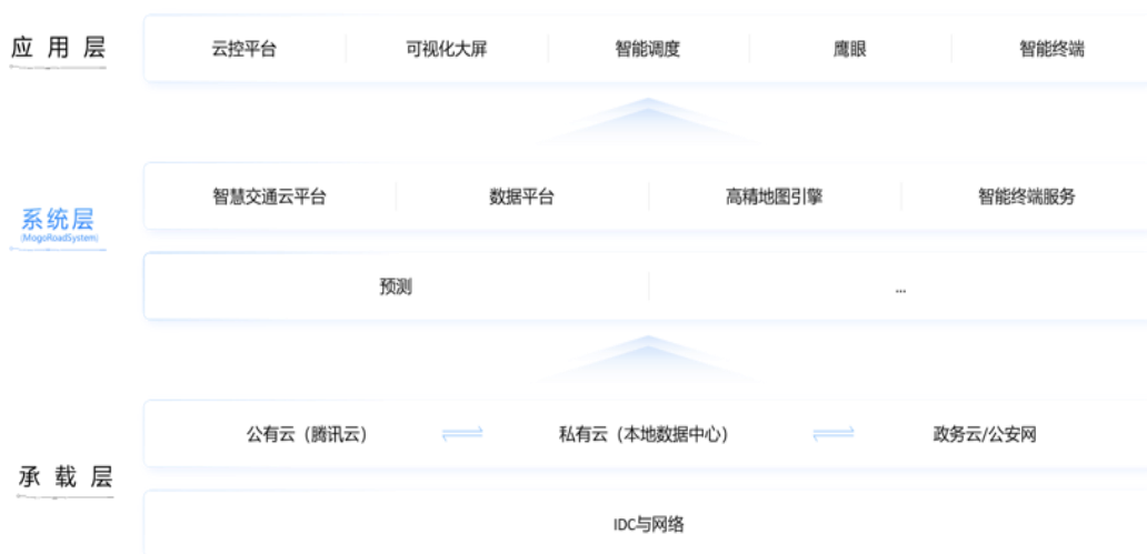
图 27：高并发+低时延的公司云端系统技术架构图
