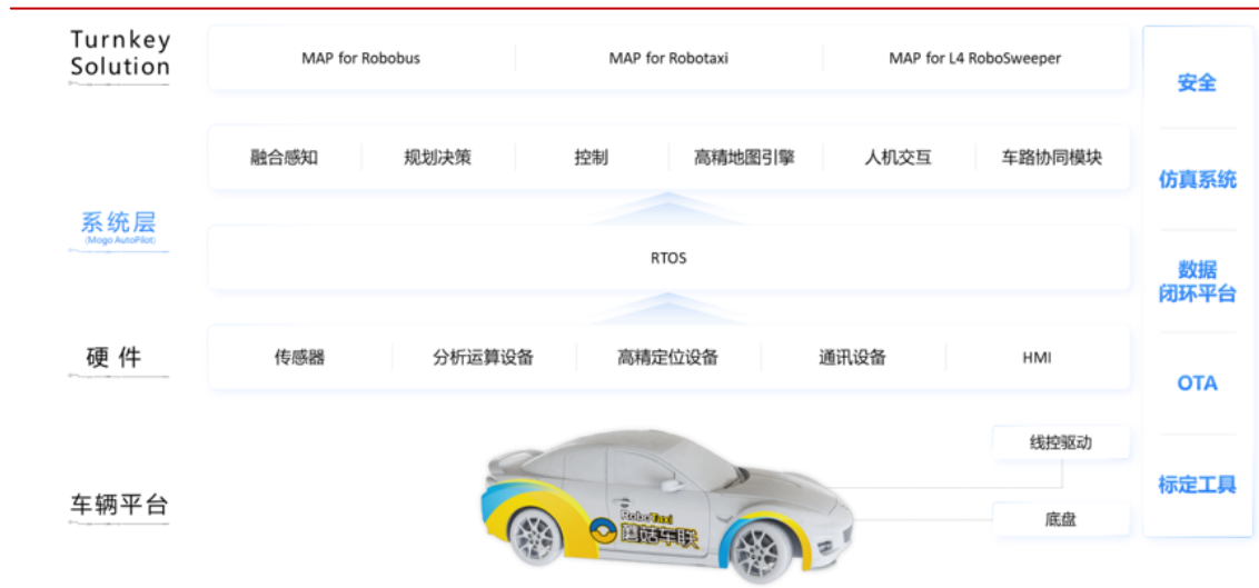
图 17：公司从车辆平台到应用层的自动驾驶单车产品架构
